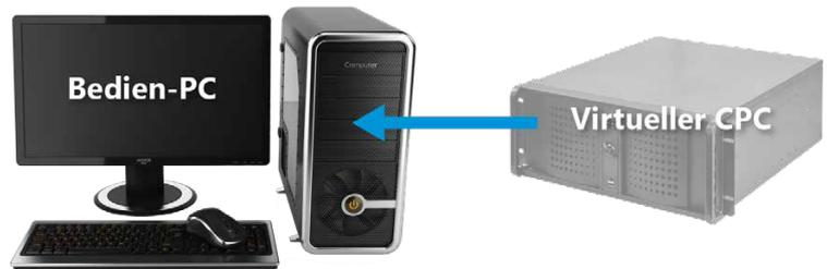
Der virtualisierte Echtzeitrechner läuft auf dem Bedien-PC, so dass dafür keine separate Hardware erforderlich ist.
