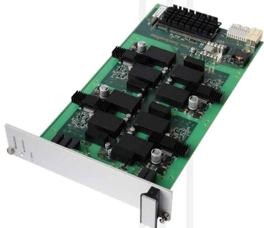
Die Karte simuliert Lade- und Entladeprozesse mit programmierbaren Zeitkonstanten von wenigen Millisekunden bis hin zu mehreren 100 ms. Zudem können Testingenieure sinusförmige Spannungen mit Frequenzen zwischen wenigen Hertz und 500 Hz auf die Zwischenkreisspannung addieren. Dadurch lässt sich die Karte als zwei unabhängige Quellen mit einer Spannung zwischen -5 und 500 V konfigurieren.
